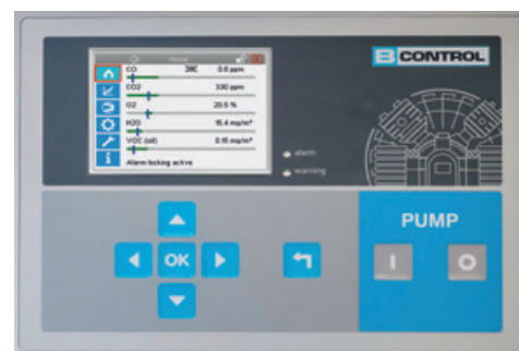
Display mit Grenzwertanzeige nach DIN EN 12021:2014
